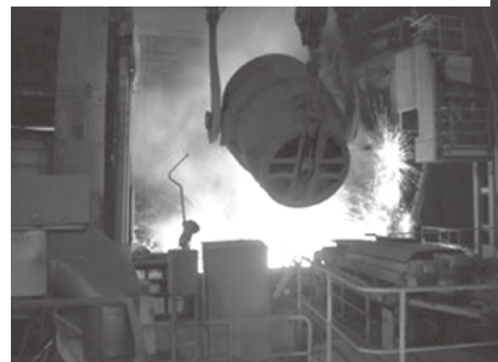
他の原材料と共に炉で溶解精錬処理
