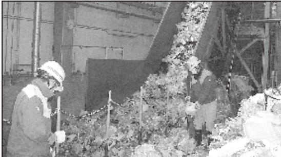
③受入コンベヤにより粗選別装置に運びます。
