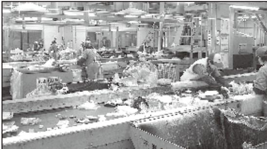
⑤手選別ラインで作業員が手作業により異物を取り除きます。
